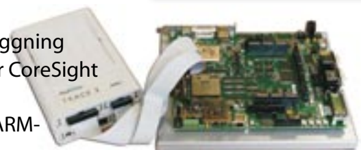
RealView ICE och Trace 2 kopplad till en ARM plattform för ARM1176JZF-S
